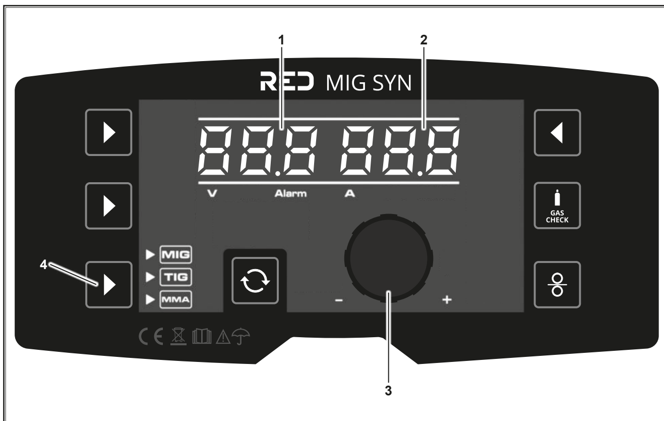
Fig. 4: Visualización del proceso de soldadura WIG
