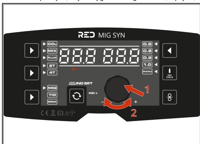
Ryc. 16: Korygowanie długości łuku (napięcia)
