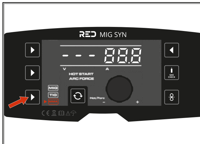
Ryc. 21: Ustawianie procesu spawania
