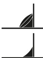
Fig. 16: Corriger la longueur de l'arc (tension)
